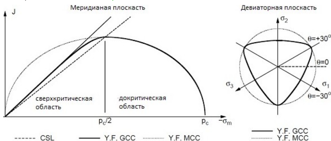
Проекция площади пластичности моделей MCC и GCC на меридианную и девиаторическую плоскость
