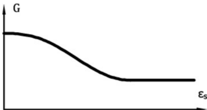
Рисунок 6: Кривая, описывающая потери жесткости модуля сдвига
