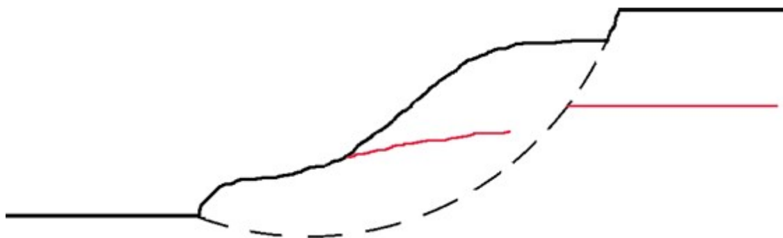
Разрыв арматуры - повреждение типа 1
