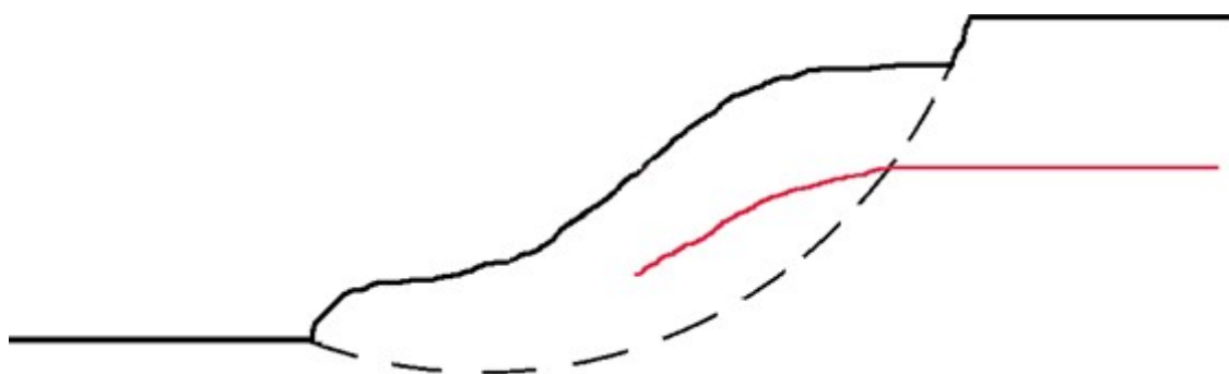
Выдёргивание арматуры из грунта перед поверхностью скольжения - повреждение типа 3
